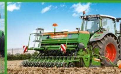
Mechanische Säkombination Cataya
