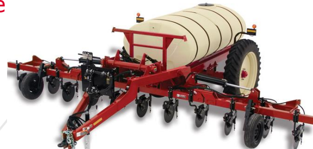
Внутрипочвенное внесение ЖКУ минимизирует потери азота до 5%
