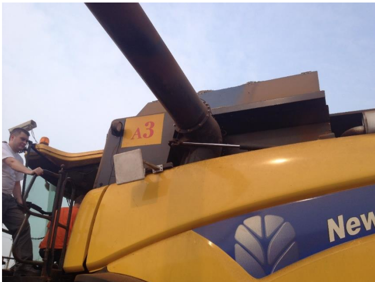
Установка записывающей антенны на корпусе комбайна
