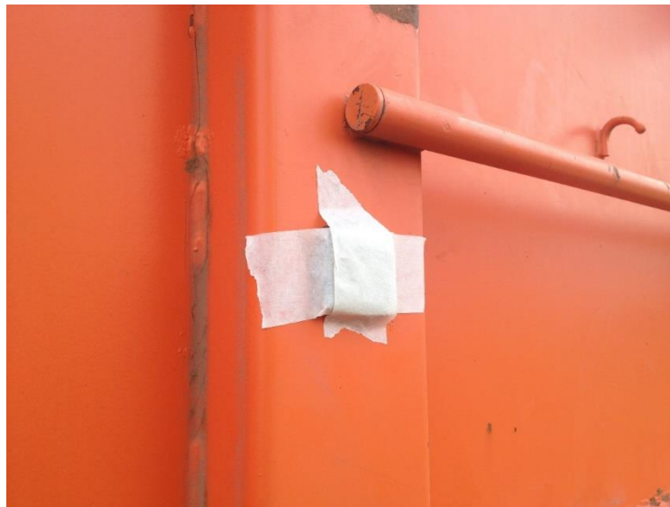
Установка RFID метки на кузове грузовика
